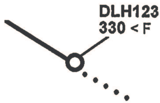
Abb.5: Darstellung eines Flugzeugs am Radarschirm der Flugsicherung.
